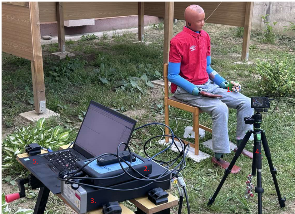
Obrázok 13. Situácia na mieste merania s rozloženou meracou technikou a pomôckami: 1 - PCB Piezotronics 3503C2060KG, 2 - Picoscope 4424, 3 - Meggit Endevco 136, 4 – rýchloběžná kamera, 5 – laptop na zber dát [4]
