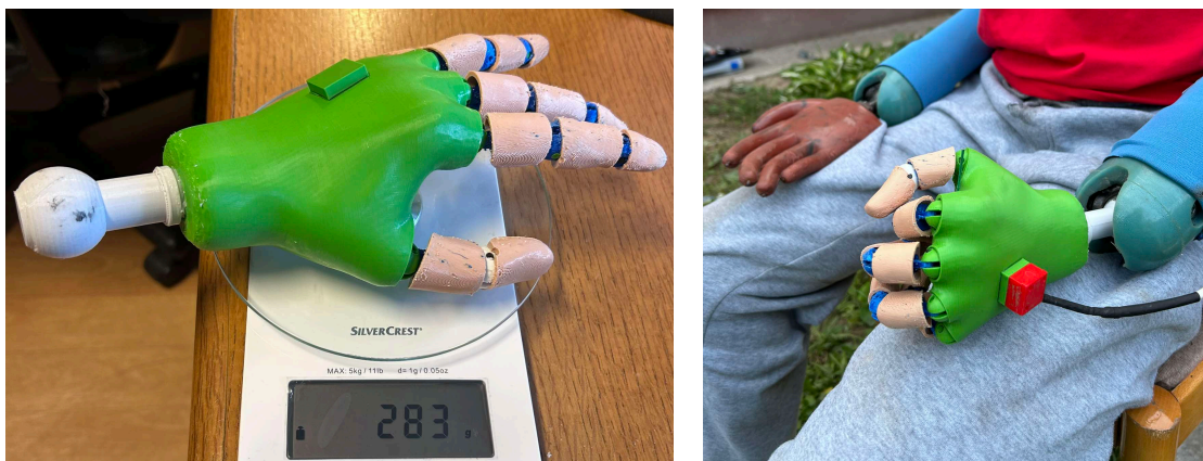
Obr. 14 Simulant ruky použitý pri testovaní (test č. 1) a detail na umiestnenie senzora zrýchlenia (PCB Piezotronics 3503C2060KG) [4]
