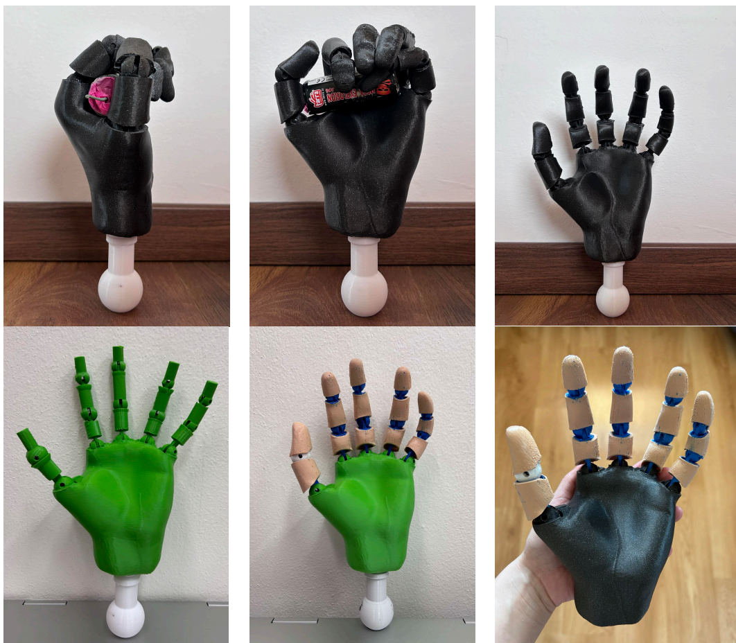
Obrázok 11 Rôzne prototypy modelu ľudskej ruky vytlačené na 3D tlačiarňi [4]
