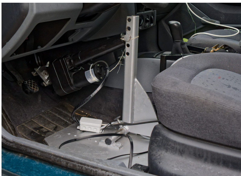
Obrázok 5 Brzdiaci systém umiestnený v skúšobnom vozidle
