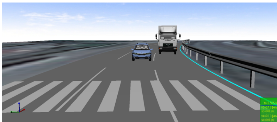
Obrázok 5 Postavenie vozidiel v čase cca 2,50 s pred zrážkou
