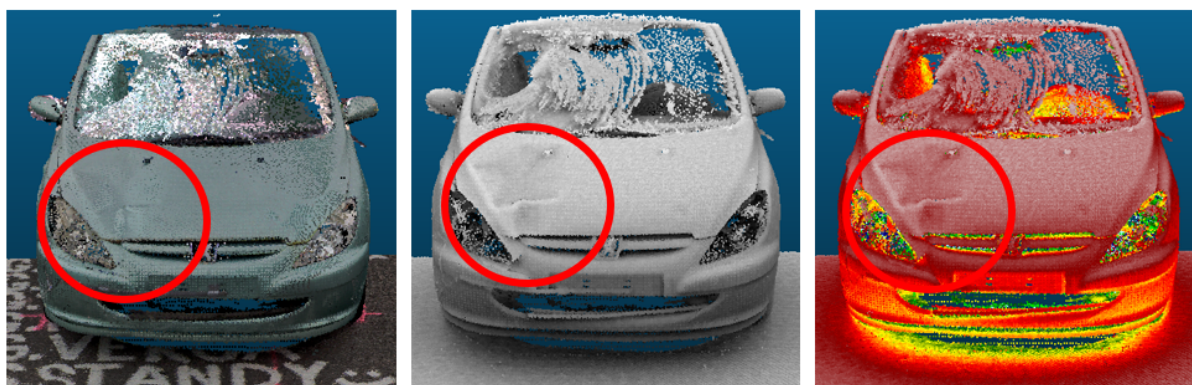
Obrázok 9 Pohľad spredu, vľavo: deformačná stopa bez farebného filtra, stred: deformačná stopa s farebným filtrom „grey“, vpravo: deformačná stopa s farebným filtrom „high contrast“
