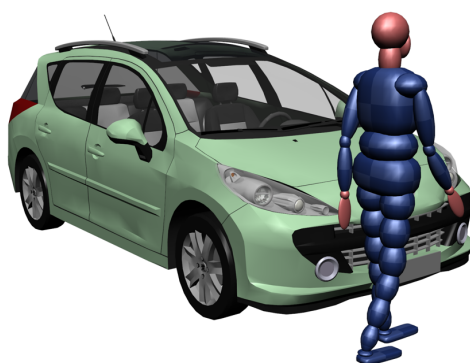
Obrázok 11 Vzájomná poloha vozidla a tela chodca v simulačnom prostredí po jej ustálení na základe korelácie medzi kontaktnými miestami na vozidle a zraneniami chodca
