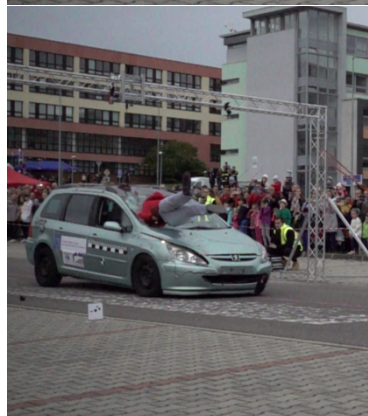
Obrázok 10 Korešpondencia medzi kontaktnými miestami na vozidle a telom figuríny (1:nárazník vs. dolné končatiny, 2: nábehová hrana kapoty vs. ľavý bedrový kĺb, 3: dolná časť trupu figuríny vs. kapota, 4: hlava vs. čelné sklo
