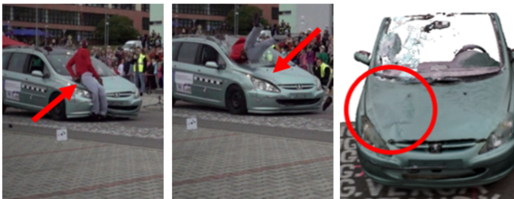
Obrázok 7 Detail deformačnej stopy na vytvorenom 3D modeli testovacieho vozidla
