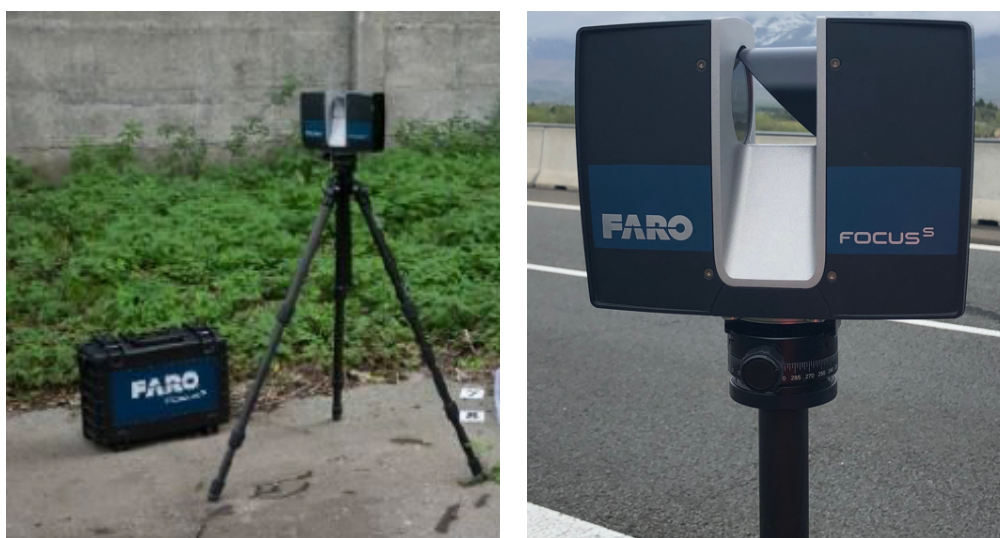
Obrázok 4 3D laserový skener Faro Focus S350 použitý na dokumentačné účely
