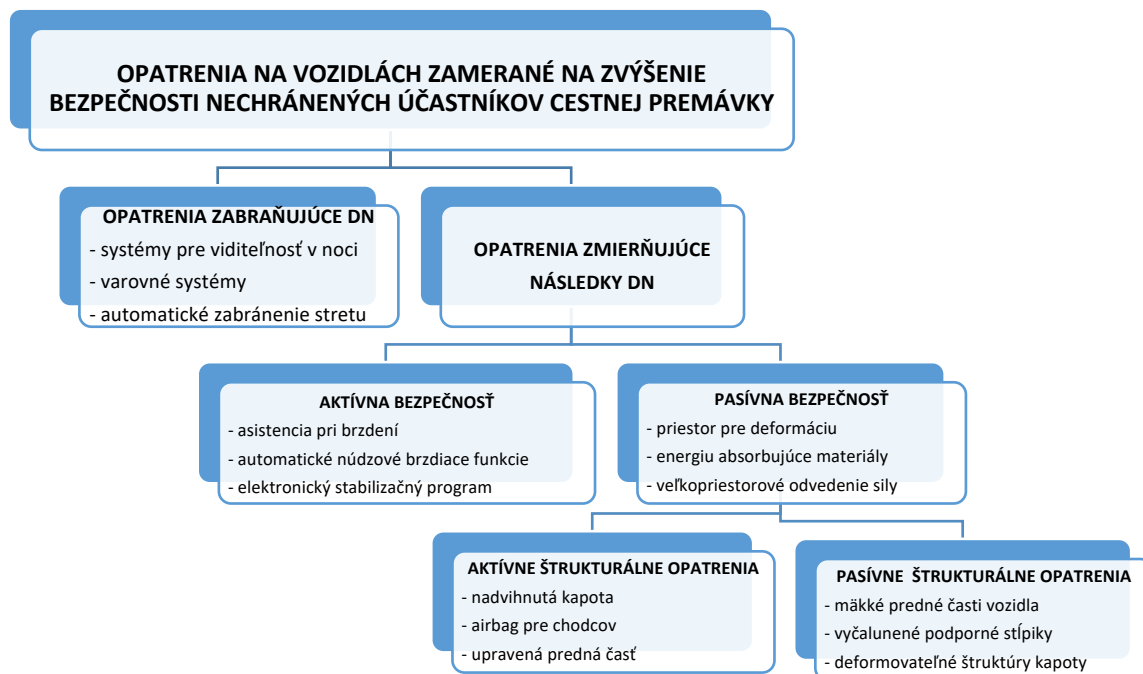
Obrázok 3 Kategorizácia opatrení na vozidlách zamerané na zvýšenie bezpečnosti nechránených účastníkov cestnej premávky [3]
