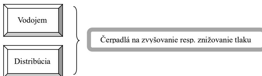
Obr. 7 Kritické miesto pri akumulácii a distribúcii vody [autor]
