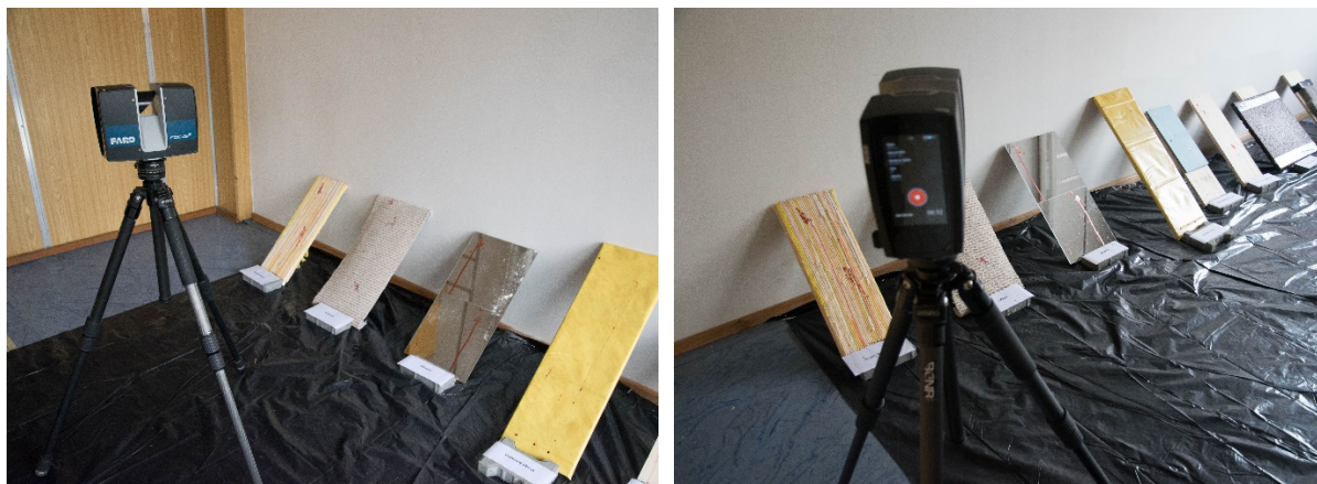
Obr. 4 3D skenovanie krvných stôp skenerom Faro Focus S 350
