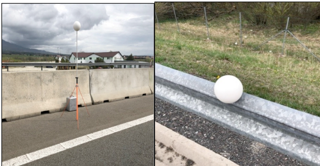
Obrázok 7 Reflexné body pre 3D skener Faro Focus s 350
