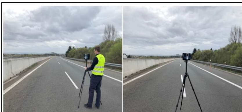
Obrázok 6 3D skenovanie diaľničného úseku pri tunely Bôrik
