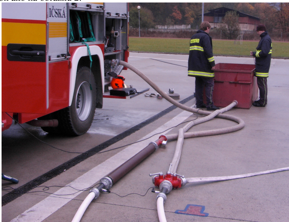
Obrázok 2 Časť meracieho systému. Meracia trubica č. 1 so snímačom tlaku, odmerná nádrž.
