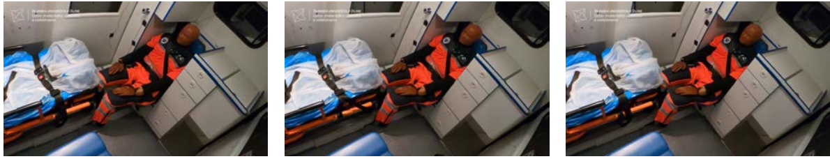
Obrázok 5 Poloha figuríny počas jazd: vľavo – pred začiatkom brzdenia, v strede – počas intenzívneho brzdenia, vpravo – po zastavení vozidla
