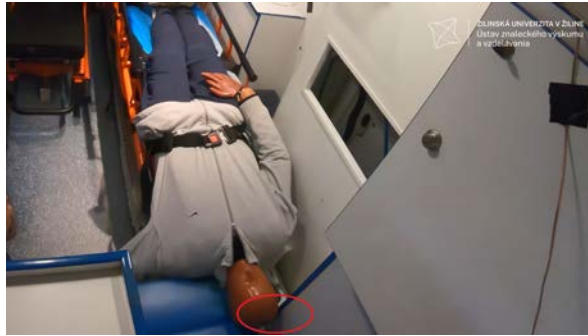
Obrázok 6 Kontakt hlavy figuríny s hranou skrinky pri jazde 7
