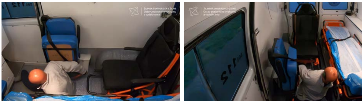
Obrázok 7 Náraz sedacej časti figuríny na podlahu vozidla pri jazde 5
