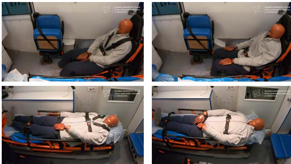
Obrázok 3 Pripútanie figuríny: vľavo - správne pripútaná, vpravo - nesprávne pripútaná
