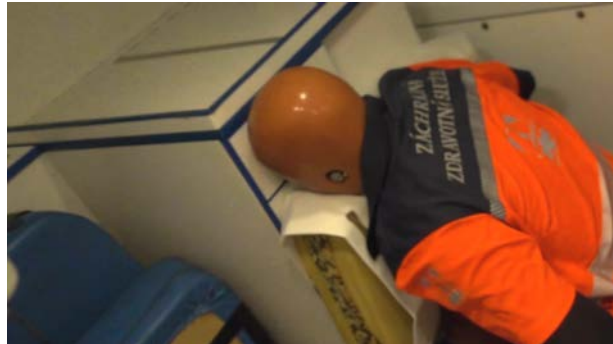
Obrázok 11 Náraz hlavy figuríny do skrinky pri jazde 12
