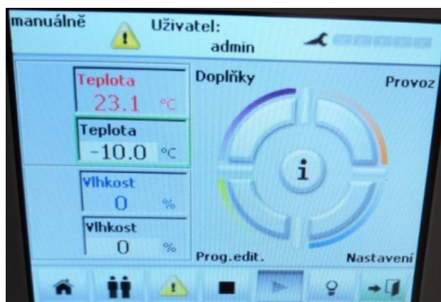
Obrázok 4 – Nastavenie teploty z 23,1 °C na -10 °C na dotykovom displeji klimatickej komory
