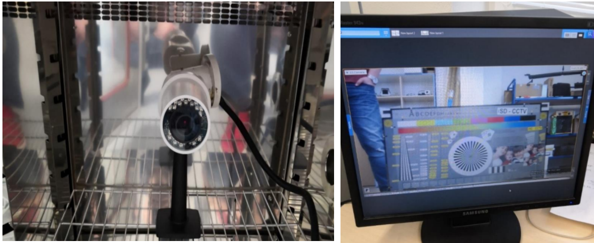
Obrázok 2 Umiestnenie kamery Dynacolor W5-BAY 30 vo vnútri klimatickej komory s výstupom na monitor
