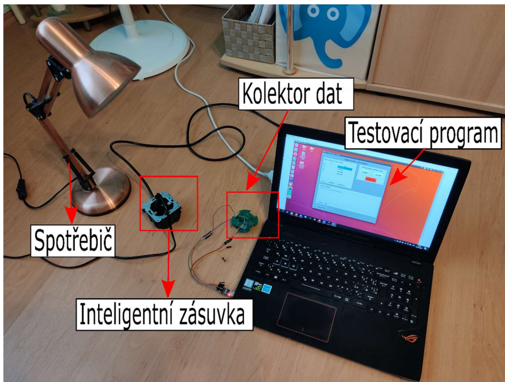
Obrázek 8: Zapojení pro testování s reálnou zásuvkou
