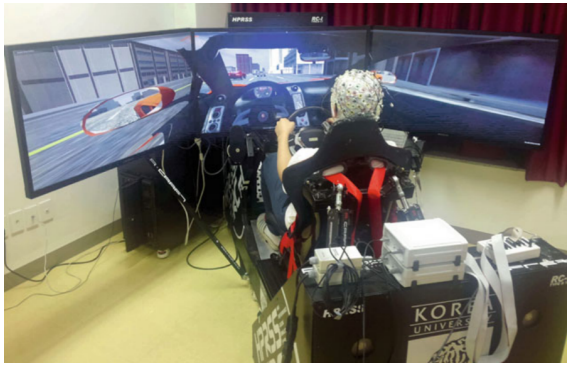
Obr. 5 Detekce brzdného účinku během simulované jízdy [11]
