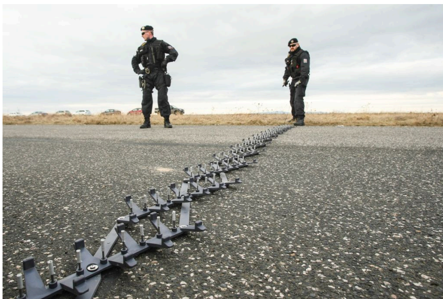
Obr. 5 – Využití bodcových systémů. 7
