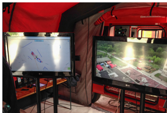
Obr. 5 – Přenos obrazu z UAV Robodrone na velitelské stanoviště při cvičení ERGON 2014 [17]
