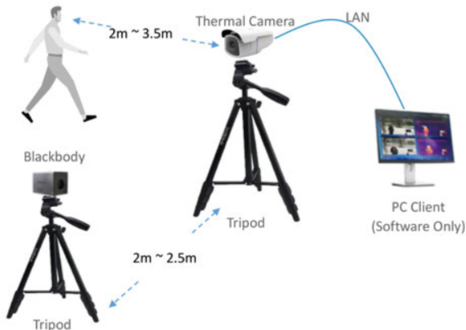
Obrázek č. 4 – Grafické znázornění technologie termokamery Uniview [5]
