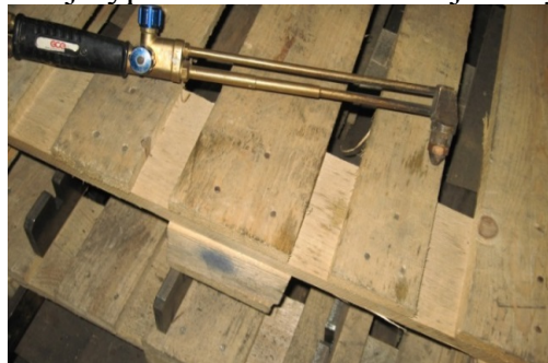
Obr. 3 Rezací nadstavec RN-7 s kolieskom pre rezanie plynom (Zdroj: vlastná dokumentácia)
